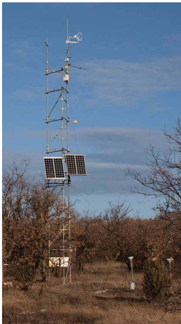
Slika 1: Raziskovalna oprema za metodo Eddy covariance na ploskvi Zaraščanje (avtor: Iztok Sinjur)
