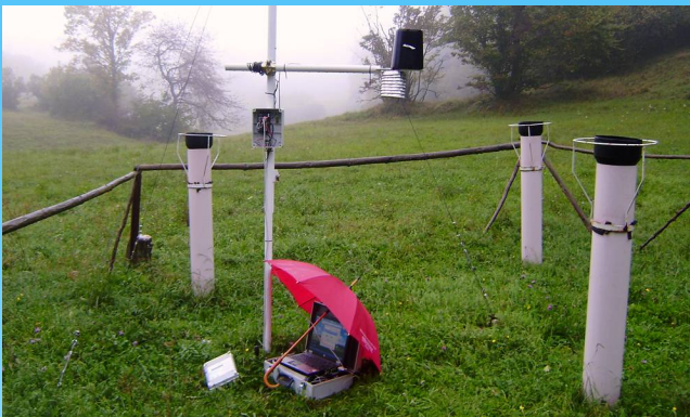
Samodejna meteorološka postaja na ploskvi Fondek
