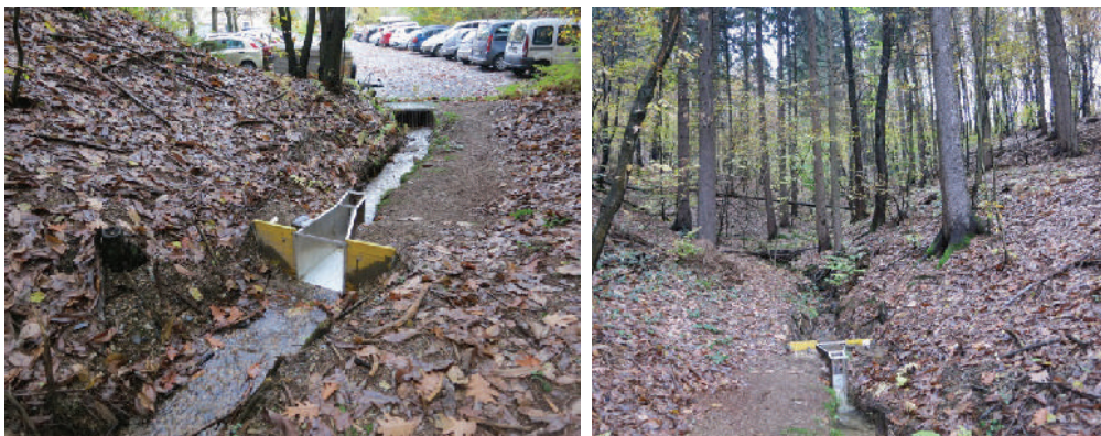
Slika 18: Preliv za meritve vodostaja na monitorinški lokaciji Rožnik (foto: Urša Vilhar)
