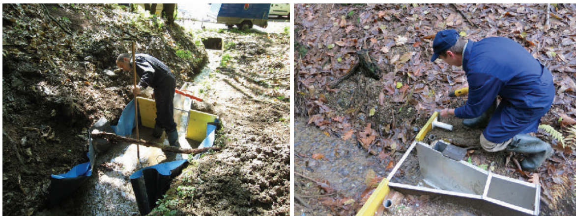
Slika 19: a) Postavitev preliva in b) namestitvev tlačnih sond za meritve vodostaja na monitorinški lokaciji Rožnik (foto: Urša Vilhar)
