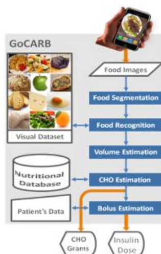
Figura 22: Proposta do modelo de Contador de Carboidratos
