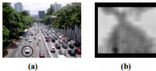
Figura 8: Rastreamento Veicular: (a) Região de Interesse que contém o veículo; (b) Objeto de interesse em destaque depois do processamento
