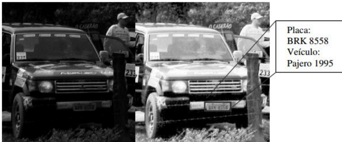
Figura 1: Veículo em imagem escura (esquerda). Após uma equalização de histograma, em nível de cinza, onde a placa do veículo pode ser lida (direita). Informação da placa e do veículo no retângulo.
