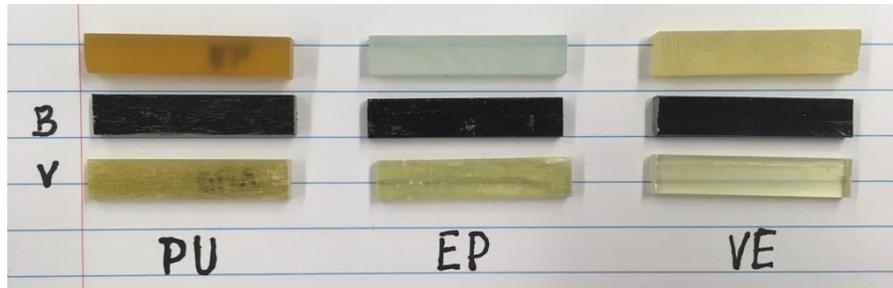
Figure 3.4 : Échantillons de résines (haut) et de composites (milieu et bas)
