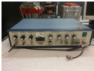
(b) Générateur des pulses ultrasonores
