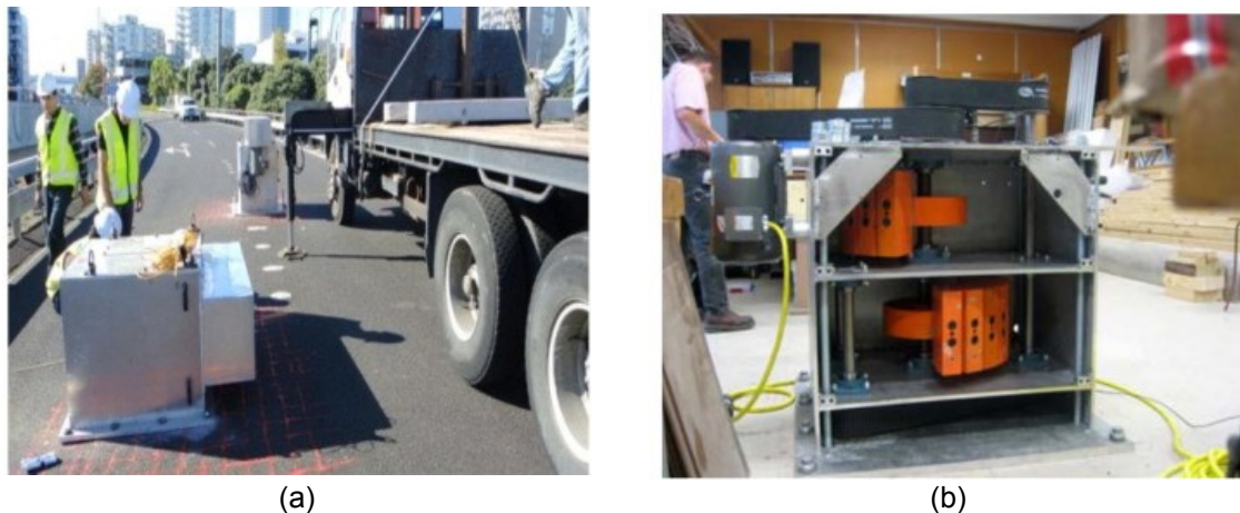
Figure 3-11 Vibreurs à masses excentrées : (a) vue extérieure et (b) intérieure du vibreur [137].
