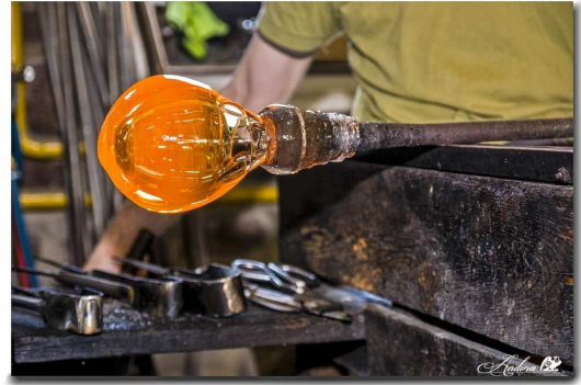
FIGURE 4 – Exemple de phase visqueuse : un verre étant soufflé
