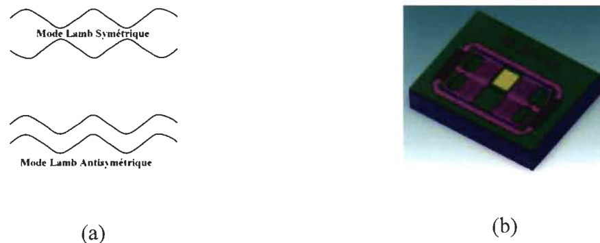
Figure 2.12 Ondes de Lamb. (a). Polarisation des ondes de Lamb, (b). Dispositif de détection à base d'ondes de Lamb.
