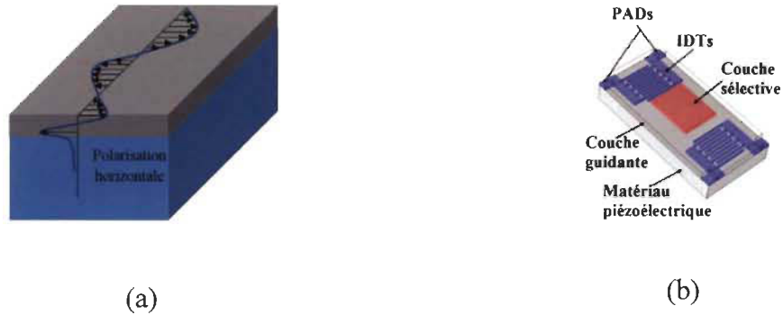
Figure 2.11 Ondes de Love. (a). Polarisation des ondes de Love, (b). Dispositif de détection à base d'ondes de Love.
