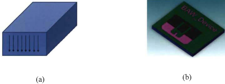
Figure 2.8 Ondes de volume «Bulk Acoustic Waves (BAW)». (a). Polarisation des ondes BAW, (b). Dispositif de détection à base d'ondes BAW.
