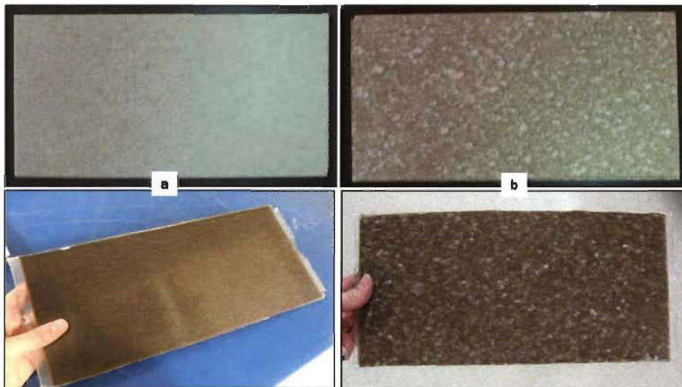
Figure II.14 Renforts lin/Kraft et composites résultants : a) Lin lavé/Kraft native, b) Lin lavé/Kraft acétylé-2h.
