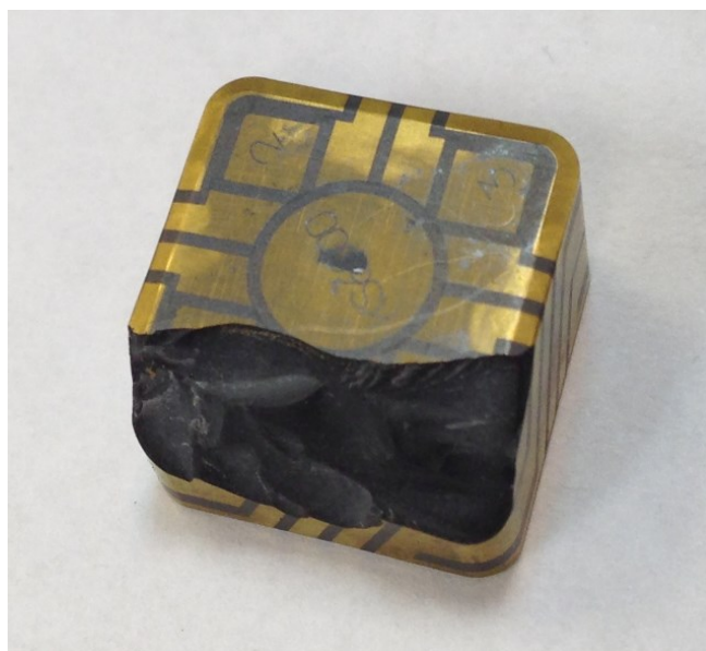
Obr. 8.15 Destrukce nástroje – řez. č. 8
