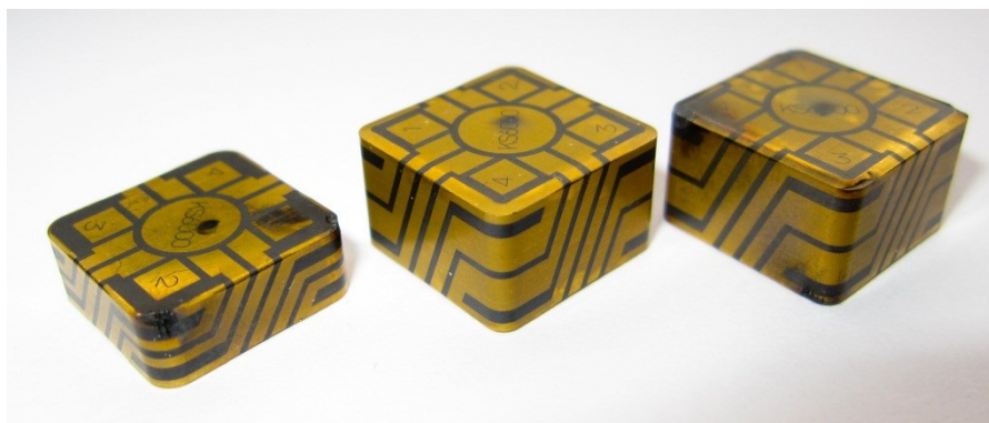
Obr. 7.5 VBD z řezné keramiky KS6000 s nanesenou odporovou vrstvou
