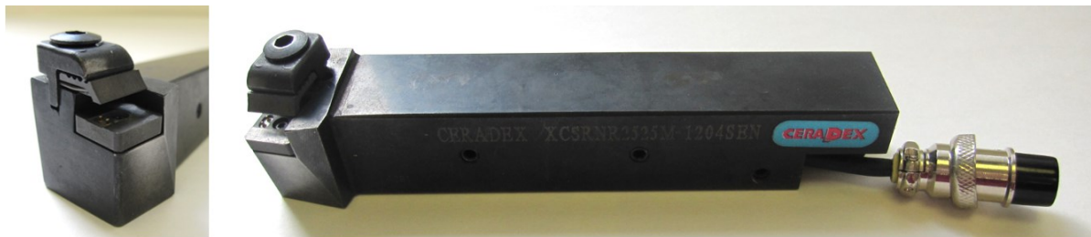
Obr. 7.7 Nástrojový držák se snímacími kontakty
