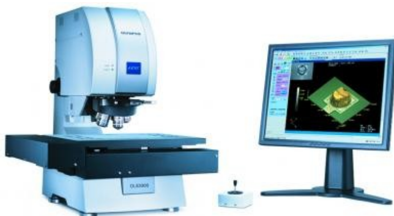
Obr. 22 Konfokální mikroskop Olympus LEXT OLS 3100 na ÚGN [53].
