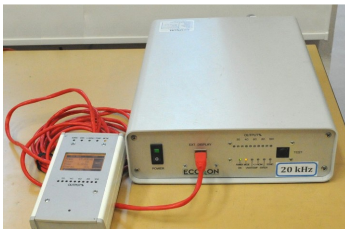
Obr. 16 Ultrazvukový 20 kHz generátor Ecoson.
