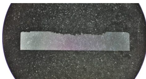
Obr. 49 Metalografický výbrus příčného profilu vzorku hliníkové slitiny AlMgSi 0,5 erodovaného pulzujícím vodním paprskem (tlak 40 \text{ MPa} , ekvivalentní průměr trysky 2 \text{ mm} , vzdálenost trysky od povrchu 73 \text{ mm} ; rychlost posuvu 2 \text{ mm}\cdot\text{s}^{-1} ).
