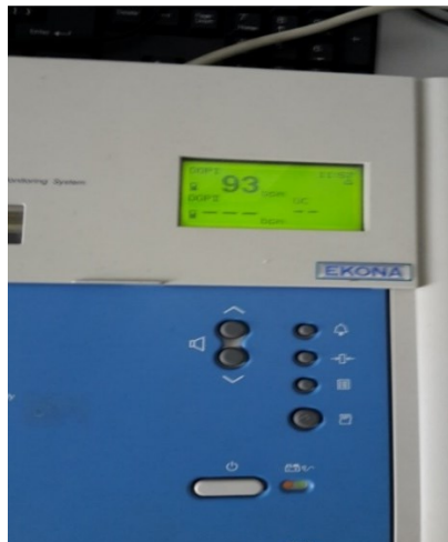
obr. 24: namerané hodnoty BFM 800 (prepínač v polohe 1)
