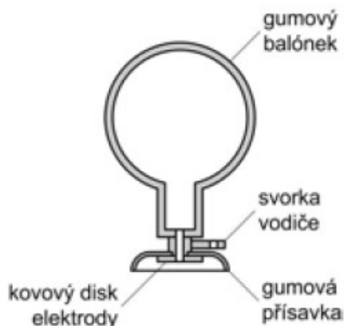
Obr. 10 Podélný řez balónkové elektrody s kovovou diskovou elektrodou, upraveno z [5]
