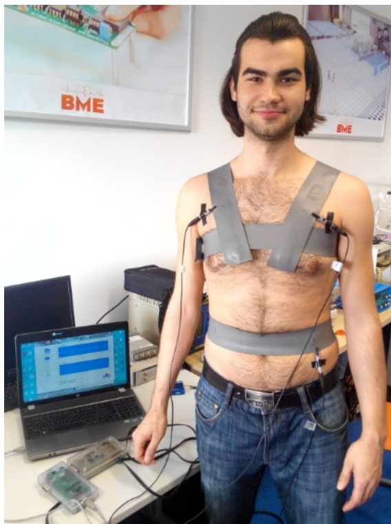
Obr. 54 Měření jednosvodového EKG na hrudníku s přilepenými krokosvorkami lepicí páskou
