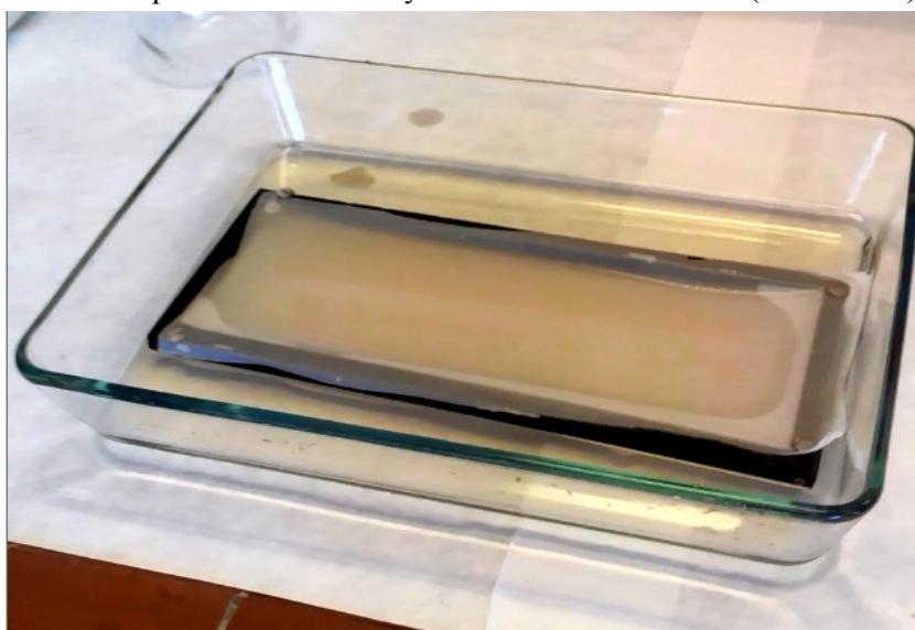
Obr. 41 Dřevěný rám s připevněnou tkaninou ponořený do roztoku Anilinu HCl
