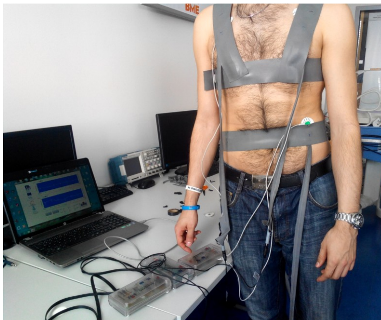
Obr. 85 Zapojení měřicího řetězce pro naměření jednosvodového EKG na hrudníku PPy elektrodami z bavlny s PANI vodiči z uhlíkového vlákna a zároveň jednorázovými nalepovacími Ag/AgCl elektrodami s klasickými vodiči
