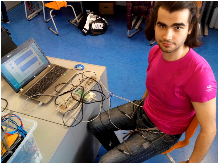
Obr. 88 Zapojení měřicího řetězce pro naměření jednosvodového EKG z trička PPy elektrodami z bavlny s PANI vodiči z uhlíkového vlákna a zároveň jednorázovými nalepovacími Ag/AgCl elektrodami (umístěných na těle) s klasickými vodiči
