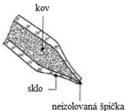
Obr. 21 Příčný řez koncové části skleněné mikroelektrody s kovovou výplní, upraveno z [9]
