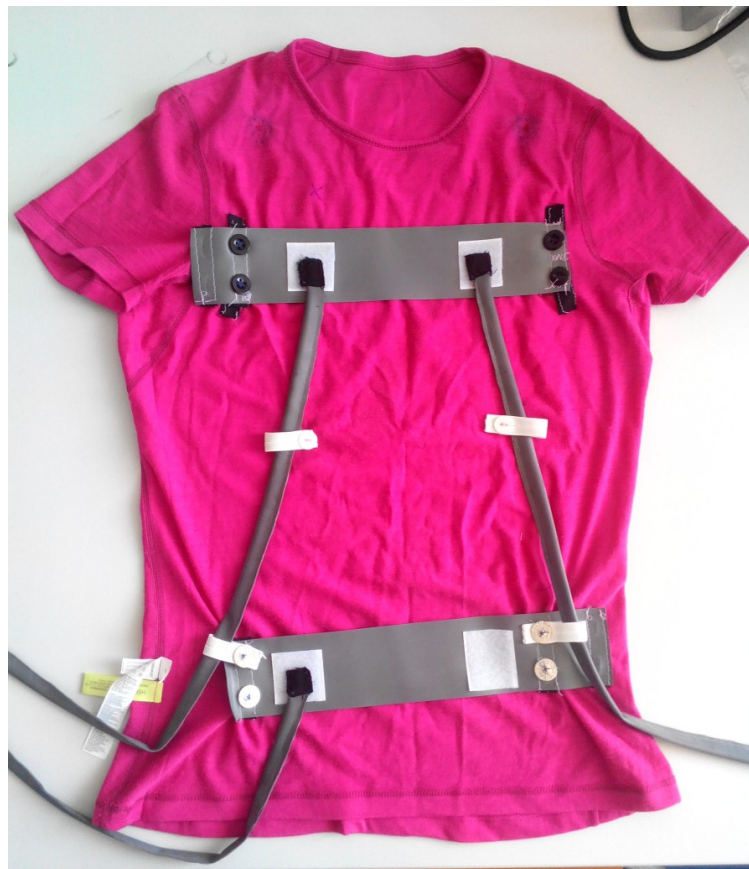
Obr. 87 Tričko s našitými obinadly a rozmístěnými polymerovými elektrodami a vodiči
