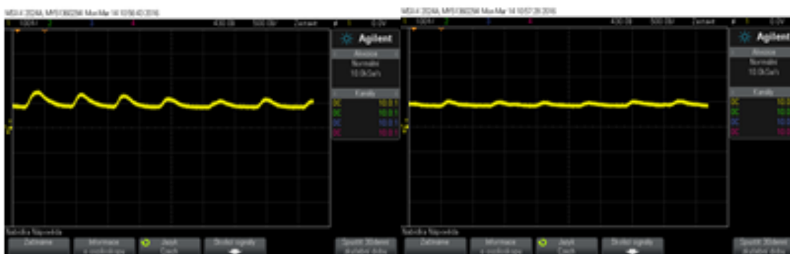
Obrázek 24 Příklad naměřeného signálu PPG, senzor umístěn na prstu (nalevo) a zápěstí (napravo)
