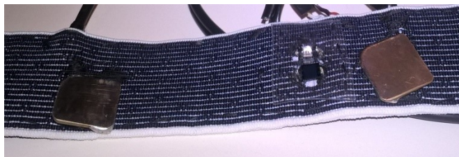
Obrázek 27 Pás s našitými snímači
