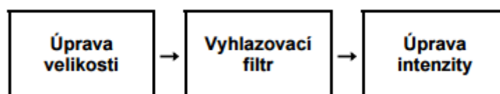
Schéma číslo 6: Blokové schéma předzpracování obrazových dat.
