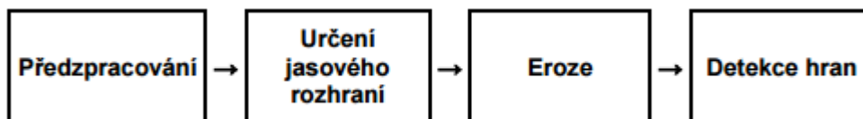
Schéma číslo 5: Blokové schéma algoritmu využívajícího hranových detektorů.
