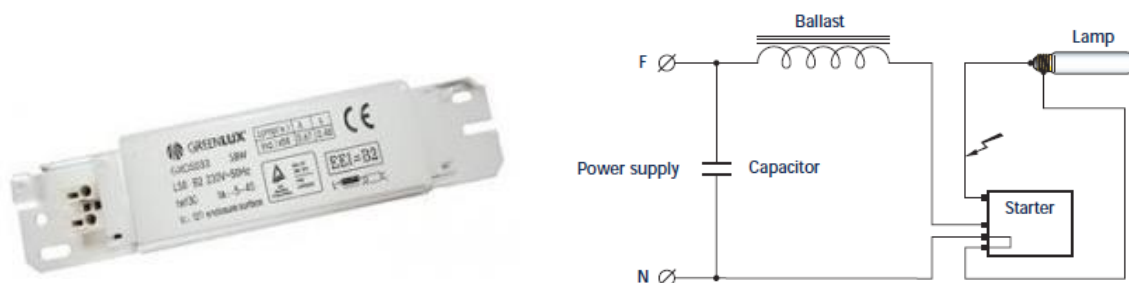
Obr. 18 Induktivní předřadník a jeho schéma zapojení s NAV
