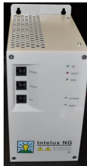
Obr. 22 Fázová regulace sestupné části (AWI) a jednotka fázového regulátoru Intelux NG [24]
