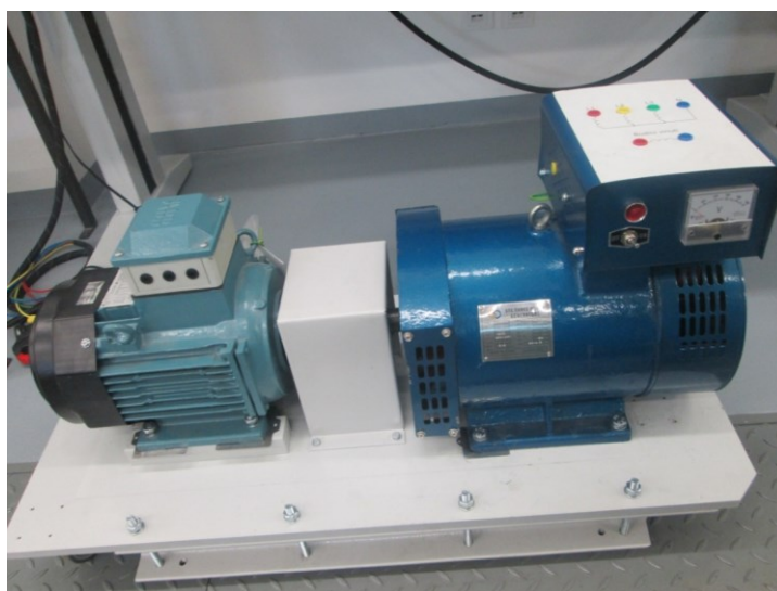
Obr. 20. Fotodokumentace soustrojí motor-generátor
