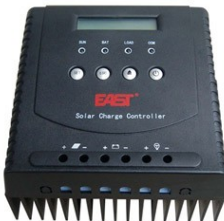
Obr. 4.2 MPPT měnič East Power GSC-F2448-60M
