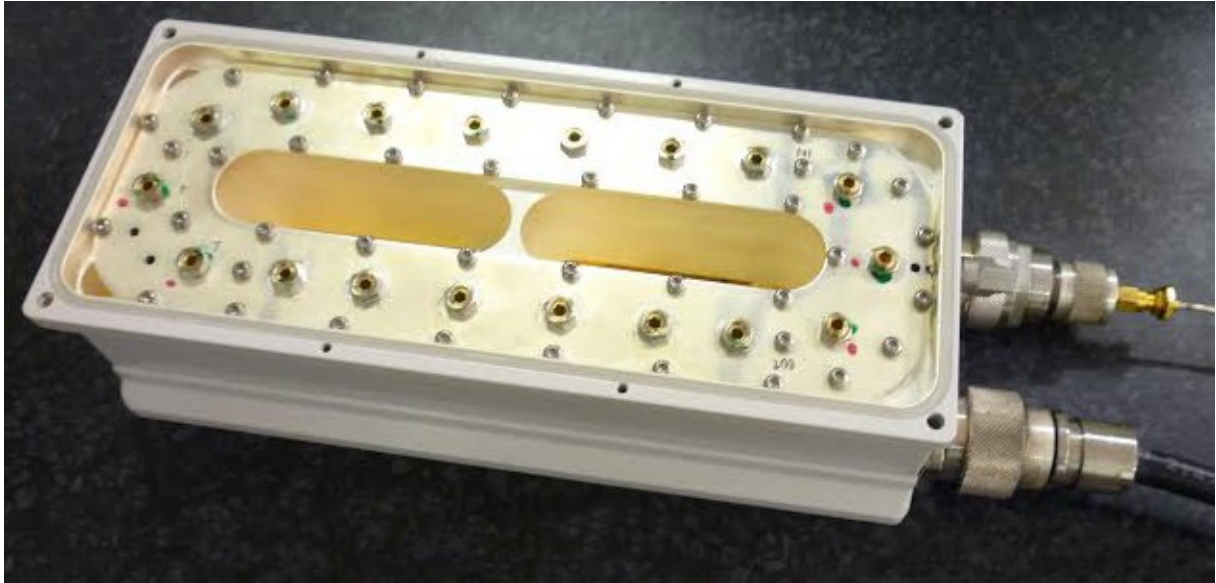
Obr. 9: Osmnácti rezonanční filtr v průběhu ladění
