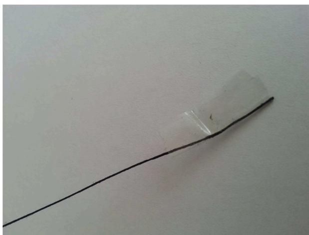
Obrázek 20 Zalepená napolymerovaná režná nit
