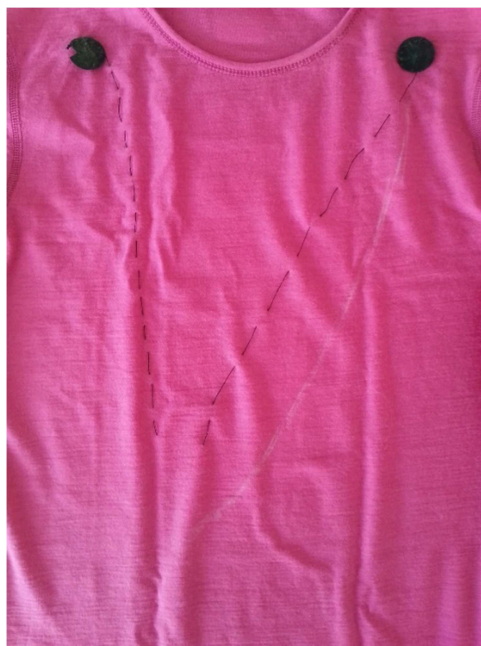
Obrázek 21 Rozmístěné svody EKG a všité napolymerované filtry
