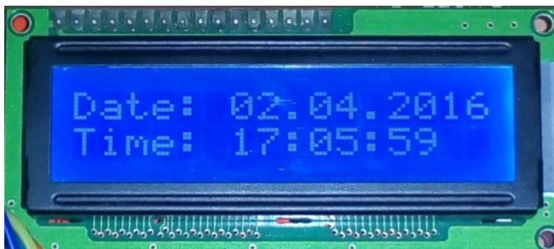
Obrázek 16 Displej WC1602-STBLWNC06 s programem pro zobrazení data a času
