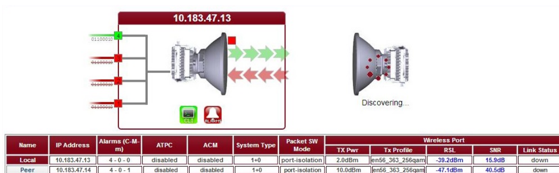
Obrázek 10: Ukázka nefunkčního spoje Harmony Enhanced
