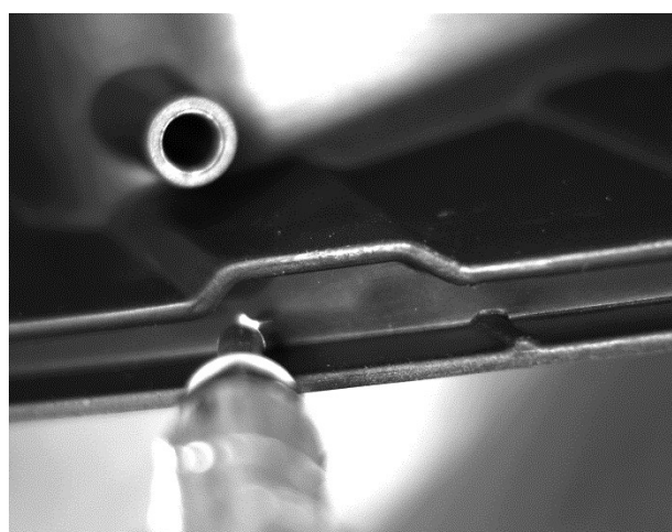
Obr. 35 Detail drážky a dávkovací jehly z kamery na robotu
