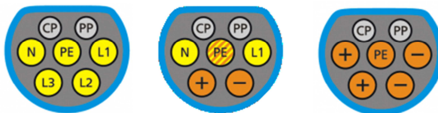
Obrázek 16 - Zapojení kontaktů u varianty AC (vlevo), DC pomalé (uprostřed) a DC střední (vpravo) [31]
