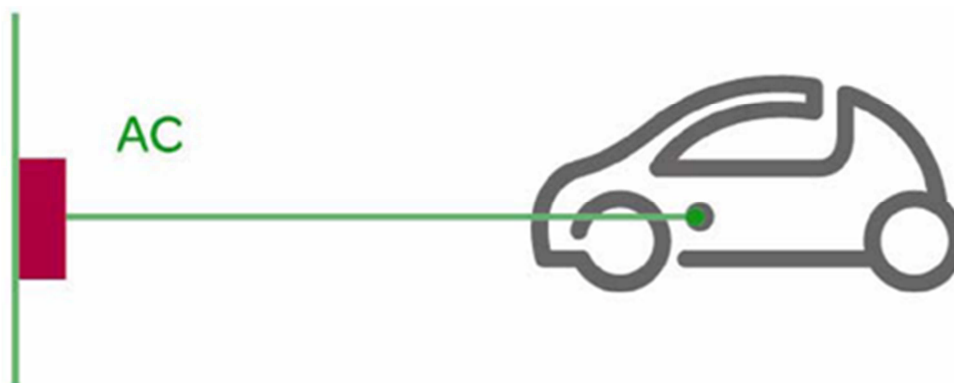
Obrázek 4 - Schéma nabíjecího módu 1 [10]
