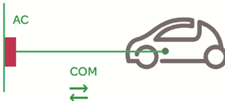
Obrázek 6 - Schéma nabíjecího módu 3 [10]
