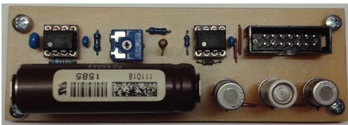
Obr. 31 Sestavený senzorový modul
