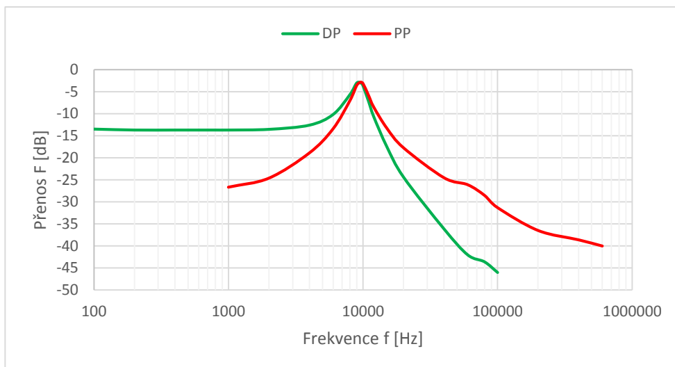
Obrázek 5.12: Amplitudové frekvenční charakteristiky TT filtru pro Q = 5
