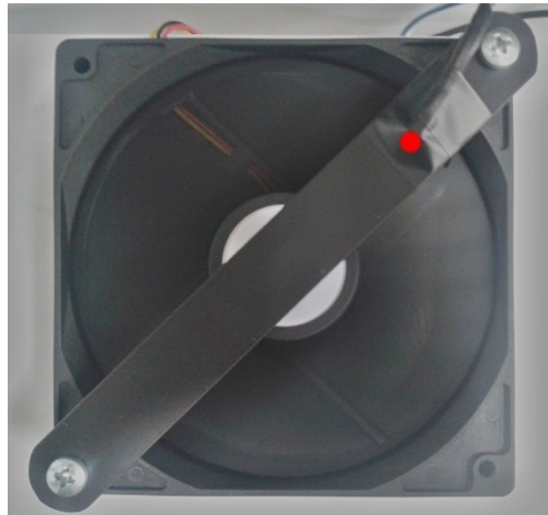
Obr. 7.2 Umístění optozávory na ventilátoru
