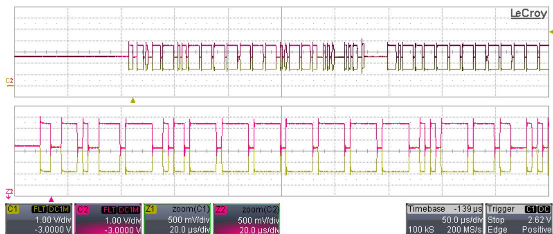
Obrázek č. 27 Průběh napětí sběrnice CAN na náhradním vedení délky 10 m
