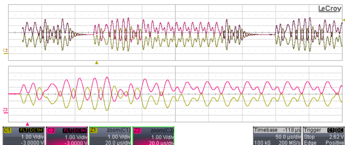
Obrázek č. 29 Průběh napětí sběrnice CAN na náhradním vedení délky 300 m.
