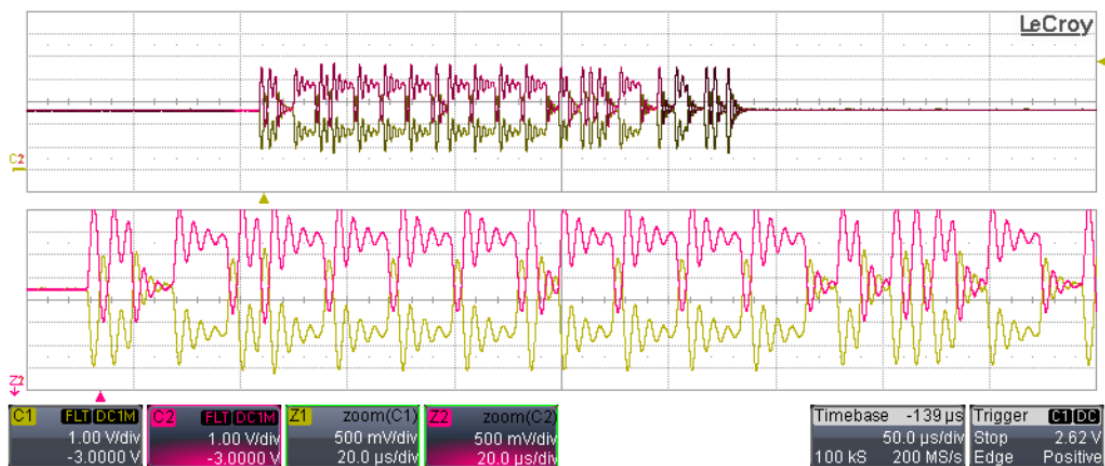
Obrázek č. 28 Průběh napětí sběrnice CAN na náhradním vedení délky 100 m
