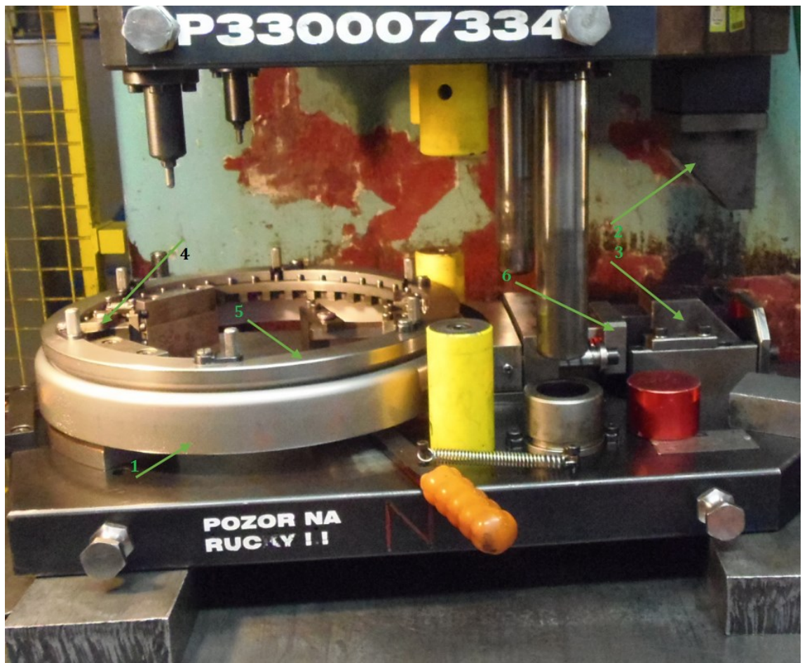
Obr. 10 Upnutí polotovaru v přípravku na lise LEK 160
