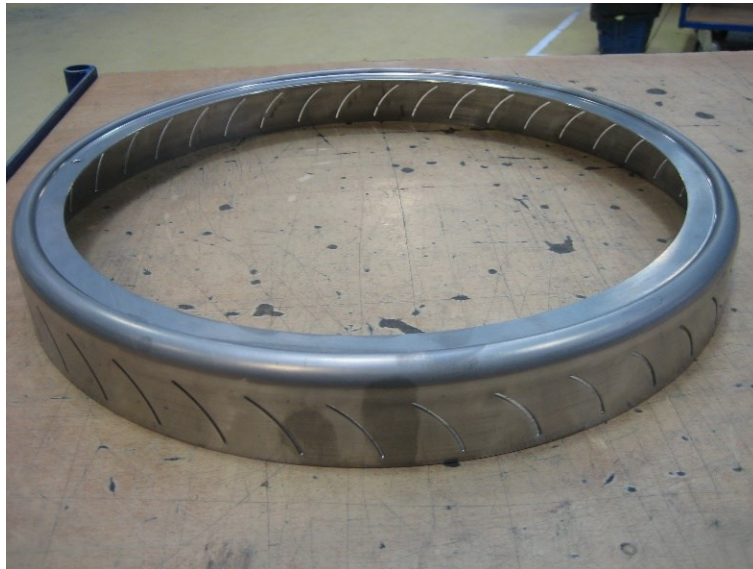
Obr. 25 Součást po děrování
