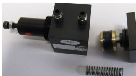
Obr. 4.38 Schéma konstrukce tlakového spínače a foto skladby diferenčního tlakového snímače
