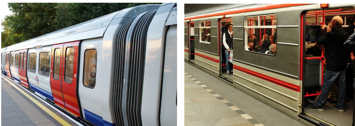
Obr. 2.7 Posuvné dveře posouvající se po stěně vozidla a zasouvající se do stěny vozidla [30]
