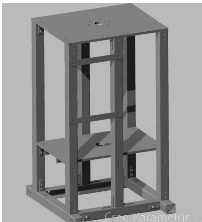
Obr. 7.1 Šroubová konstrukce zkušebního zařízení
