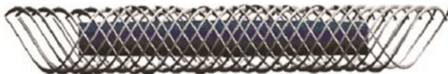
Obr. 4.4 Opletení McKibbenova svalů [9]
