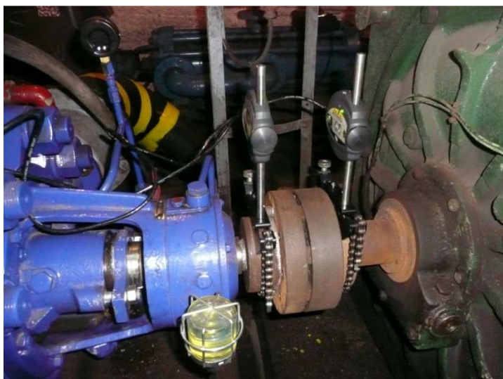
Obrázek 31 Připojení držáků měřících jednotek na spojku
