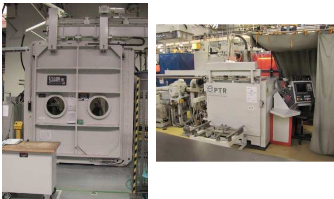
Obr. č. 21 – Elektronový paprsek Sciaky a PTR [38]
