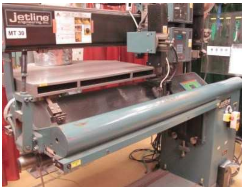
Obr. č. 19 - Poloautomatizované svařovací pracoviště TIG (141) pro podélné svary
