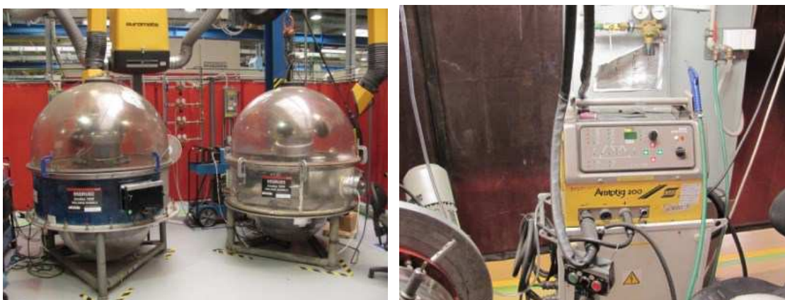
Obr. č. 20 – Svařování v ochranné atmosféře a svařovací zařízení
