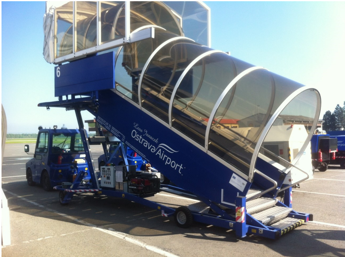
Obrázek 3.5: Kryté vlečené schody s mikropojedem
