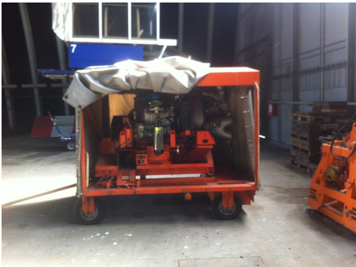
Obrázek 3.10: Mobilní generátor vzduchu pro klimatizační jednotku
