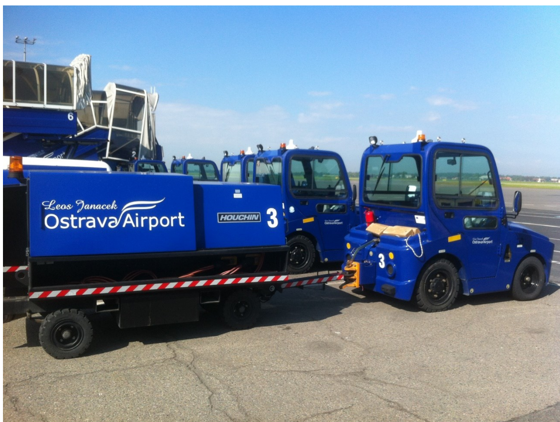
Obrázek 3.9: Mobilní pozemní zdroj GPU s tahačem, který lze použít na tahání letadel
