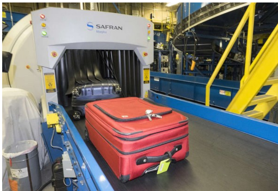
Obrázek 3.2 Rentgen v třídírně zavazadel [10]
