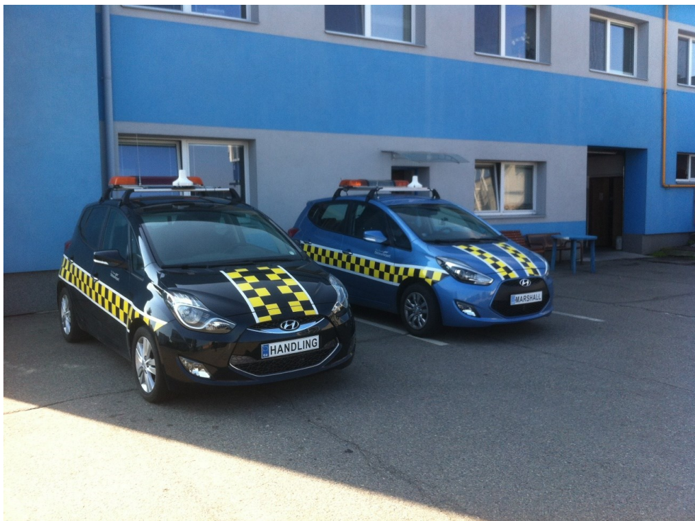
Obrázek 3.8: Vozidlo Follow me (vpravo). Bílý klobouček je ADS-B odpovídač
