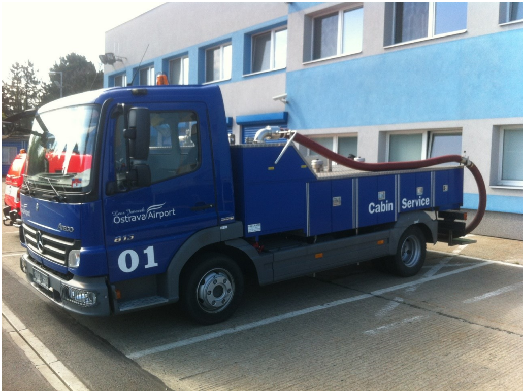
Obrázek 3.11: Zařízení pro obsluhu toalet
