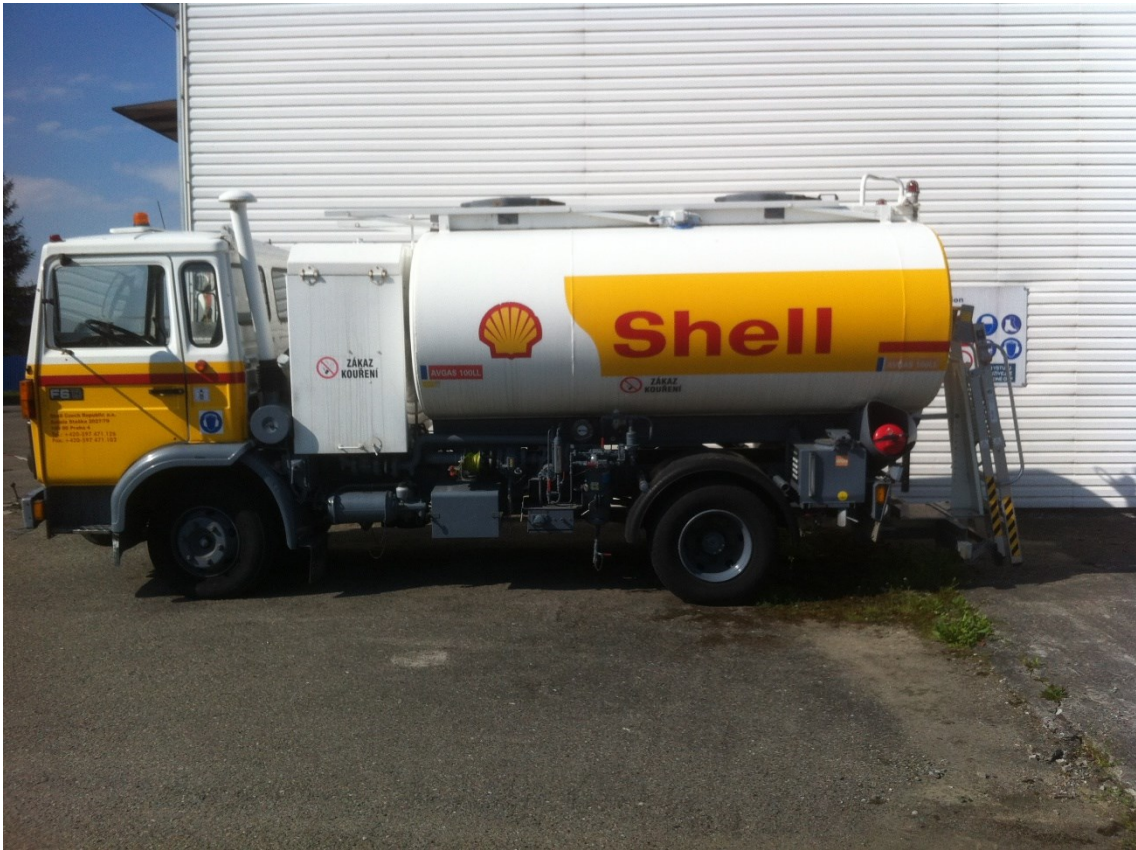
Obrázek 3.14: Cisterna pro plnění palivem Avgas 100LL pistolí
