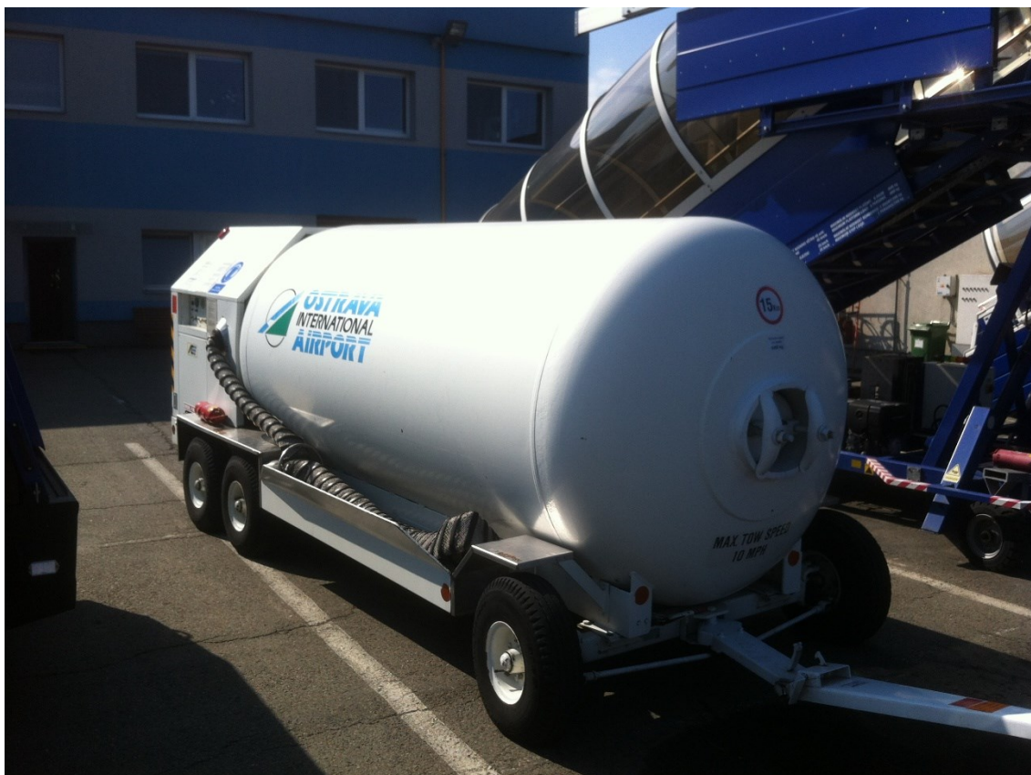
Obrázek 3.16: Externí vzduchový startér
