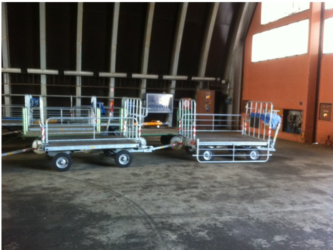
Obrázek 3.2: Vozík na zavazadla s možností zakrytí plachtou
