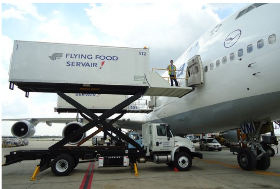
Obrázek 3.13: Vůz pro doplňování palubního občerstvení [8]
