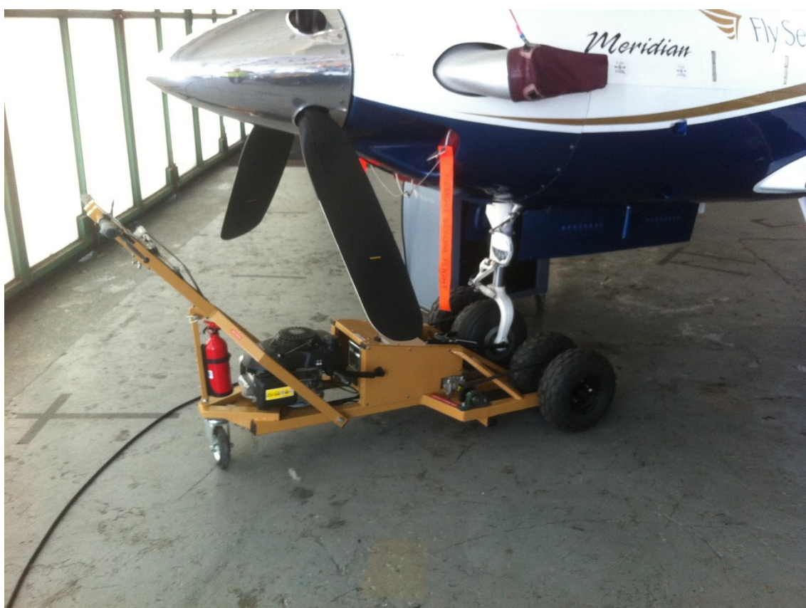
Obrázek 3.18: Ruční tahač pro malá letadla (zhruba do 10t podle výkonu tahače)
