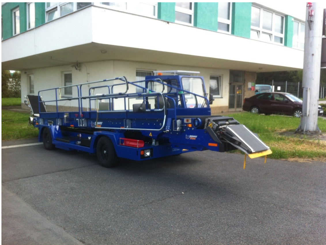
Obrázek 3.4: Pásový dopravník na zavazadla Power stow®
