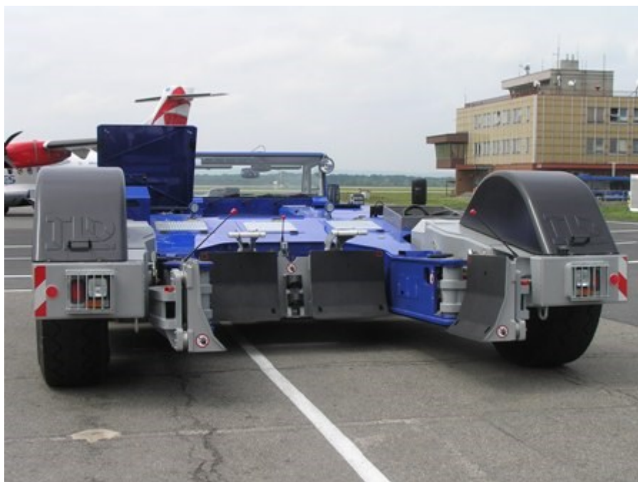
Obrázek 3.17: Bezojový tahač pro velká letadla [7]
