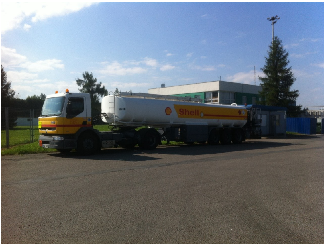
Obrázek 3.15: Cisterna pro tlakové plnění palivem Jet-A1
