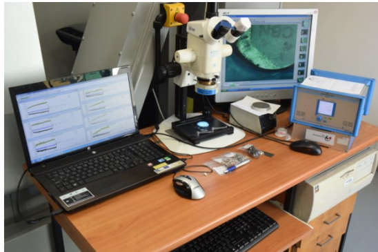
Obr. 4.8 Laboratorní sestava pro měření opotřebení nástrojů
