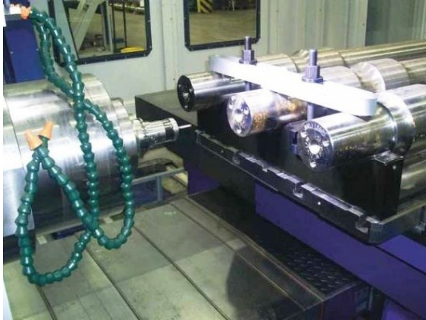
Obr. 3.5 Vrtání, řezání závitů na CNC horizontálním stroji WHN 110Q [18]
