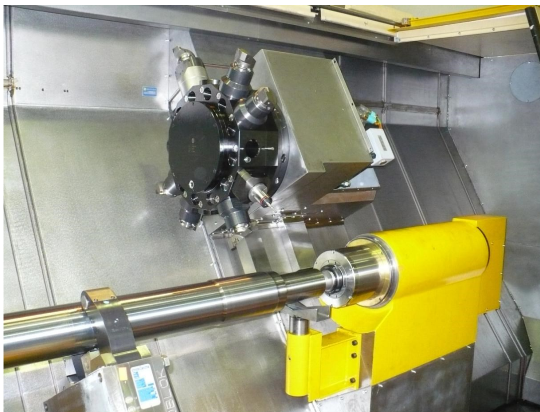
Obr. 3.4 Pohled na dokončování nápravy na soustruhu SPH 50D [15]
