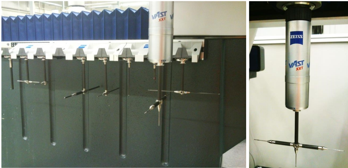
Obr. 5.7 Snímací hlava VAST XXL T 3 se snímačem a zásobníkem dalších typů snímačů
