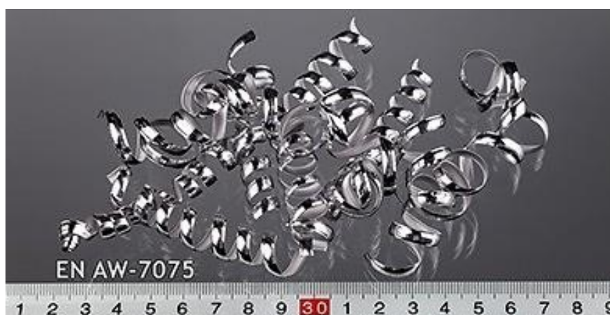
Obr. 4.10 Obrobené třísky soustružením z materiálu EN AW 7075 [29]
