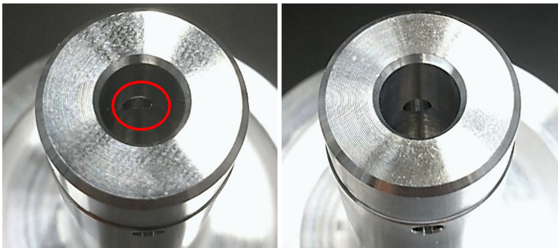
Obr. 6.2 Detail vzniklého otřepu po vyvrtání díry (vpravo součást po úpravě pořadí operací v CNC programu)
