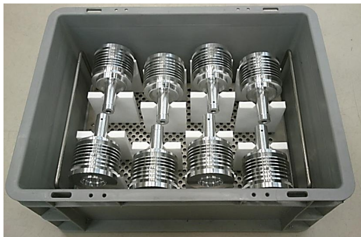
Obr. 6.7 Naplněný přepravní mycí přípravek vložený do euro bedny
