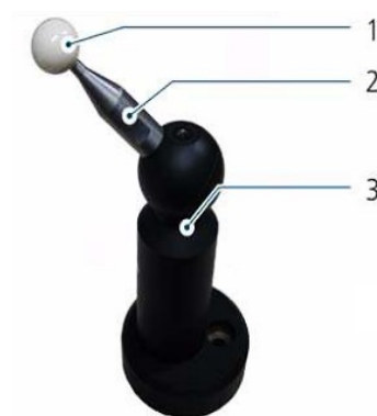
Obr. 5.8 CMM kalibr (1 – kalibrační koule, 2 – nástavec, 3 – držák) [24]
