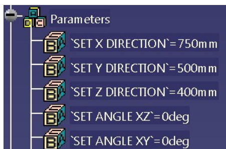
Obr. 29 – Parametry ovlivňující polohu přípravku vůči světlometu
