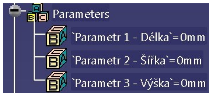
Obr. 17 – Parametry ovlivňující rozměry modelu
