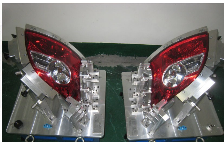
Obr. 7 – Kontrolní měřící přípravek světlometu [21]
