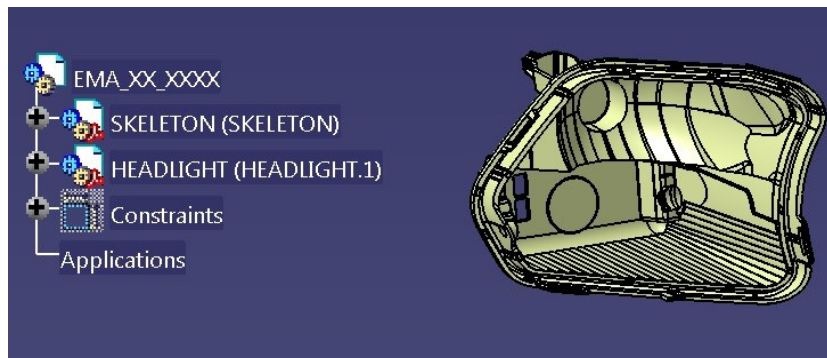
Obr. 27 – Vložení světlometu do manuálně modifikované struktury (současný stav)
