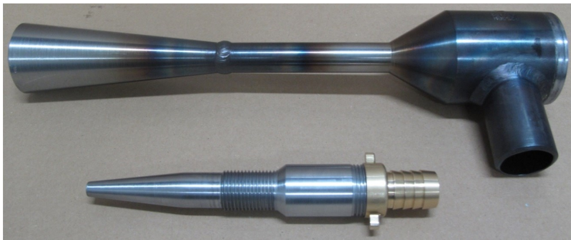
Obrázek 7-1: Proudový kompresor s regulovatelnou dýzou [v. t.]
