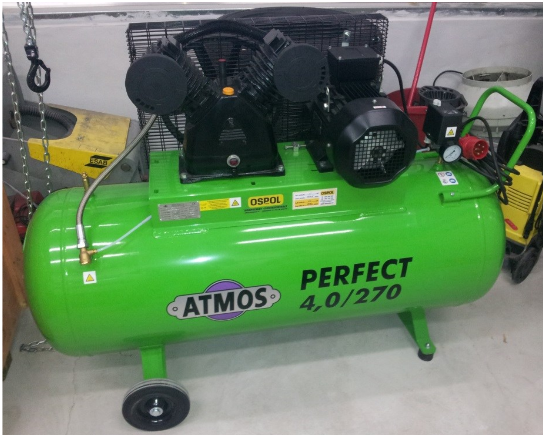
Obrázek 6-1: Pístový kompresor Atmos Perfect [v. t.]
