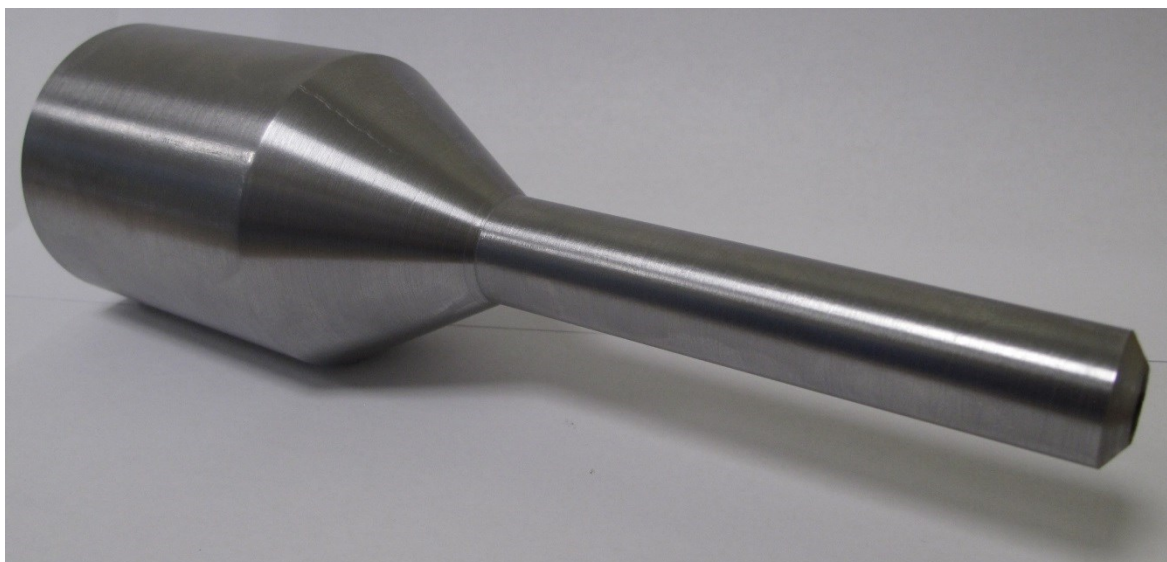
Obrázek 7-7: Sestava hlavy a směšovací komory [v. t.]
