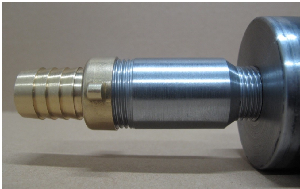
Obrázek 7-11: Připojení vstupního potrubí s dýzou k hlavě PK [v. t.]
