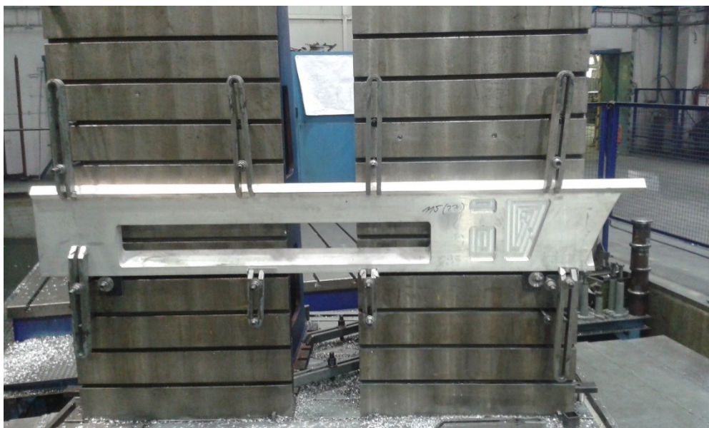
Obr. 3 – Upnutý prahový díl na otočném stole WRD 130
