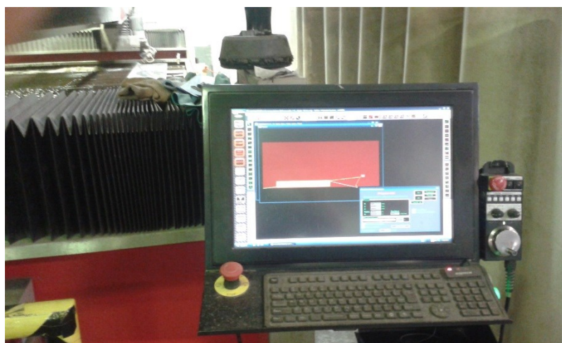
Obr. 23 – Najetí nulových bodů a zapsání do softwaru
