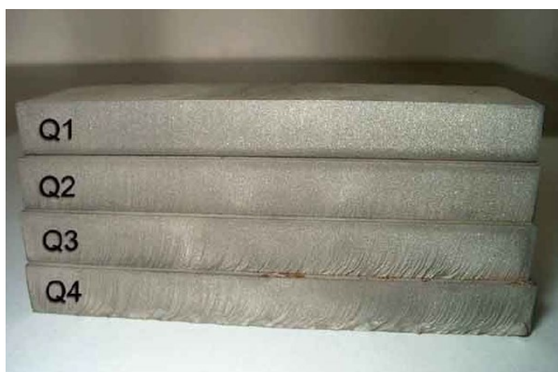
Obr. 21 – Kvalita řezu vodního paprsku
