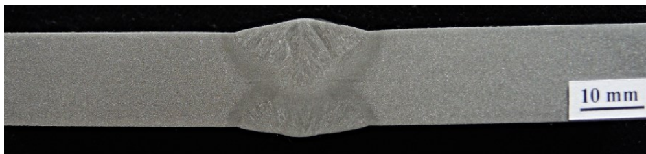
Obr. 22 Makrostruktura svárového spoje vzorku č. 2
