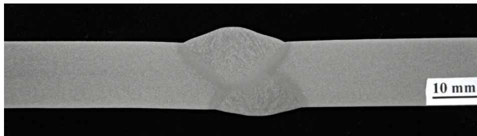
Obr. 26 Makrostruktura svárového spoje vzorku č. 3
