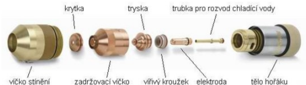
Obr. 1 Součásti hořáku [1]
