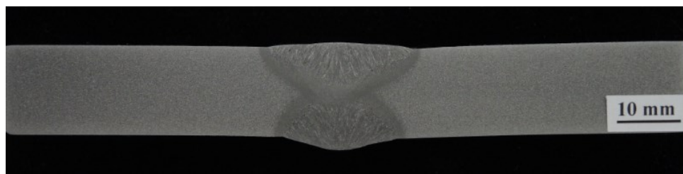
Obr. 30 Makrostruktura svárového spoje vzorku č. 4
