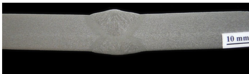
Obr. 18 Makrostruktura svarového spoje vzorku č. 1
