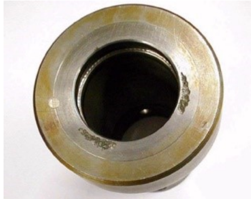
obr. č. 12 – Štěrbínová koroze na korozivzdorné oceli. [5]
