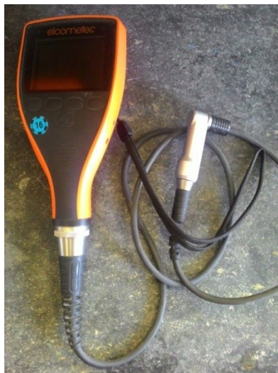
obr. č. 65 – Měřidlo ELCOMETER na měření suché tloušťky nátěru.
