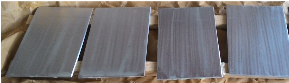
obr. č. 62 – První vrstva nano nátěru na aluminiové plechy.
