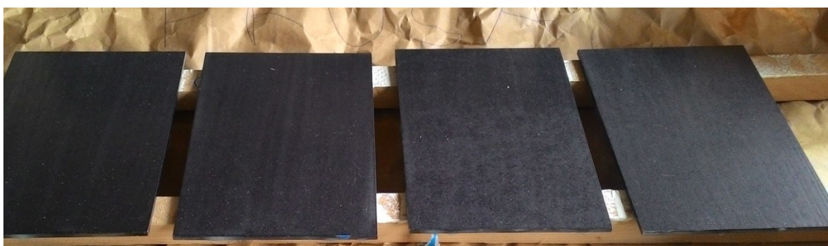
obr. č. 63 – První vrstva nano nátěru na ocelové plechy.
