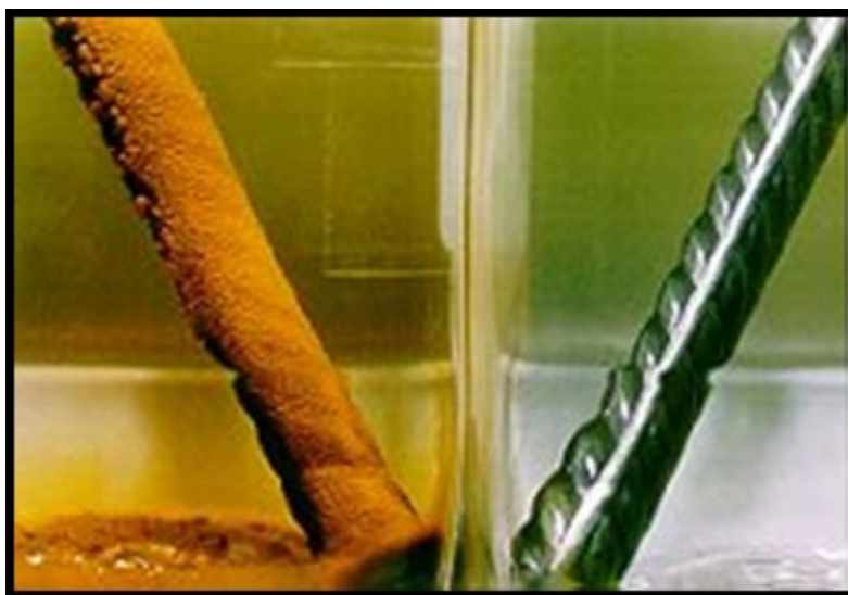
obr. č. 44 – Rozdíl mezi ocelí neopatřenou inhibitory koroze a ocelí opatřenou inhibitory koroze v korozním prostředí vody. [31]
