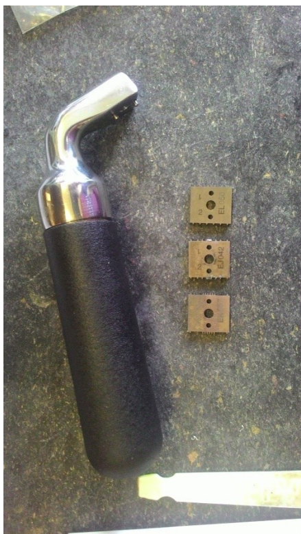
obr. č. 71 – Nůž na vytvoření pravouhlé mřížky.
