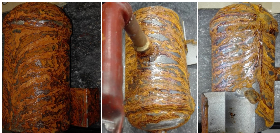
Obrázek č. 81 – Otryskané tlakové nádoby 4 B – po korozní zkoušce v korozní komoře
