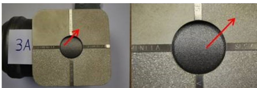
Obrázek č. 42 – Stanovení drsnosti – Tlaková nádoba 3 A
