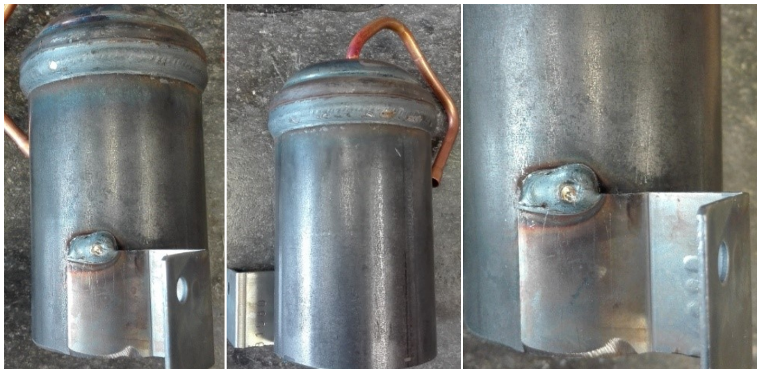
Obrázek č. 82 – Neotryskané tlakové nádoby 4 A – před korozní zkouškou v korozní komoře
