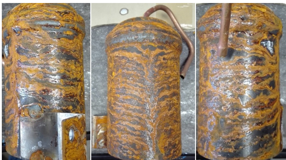
Obrázek č. 83 – Neotryskané tlakové nádoby 4 A – po korozní zkoušce v korozní komoře
