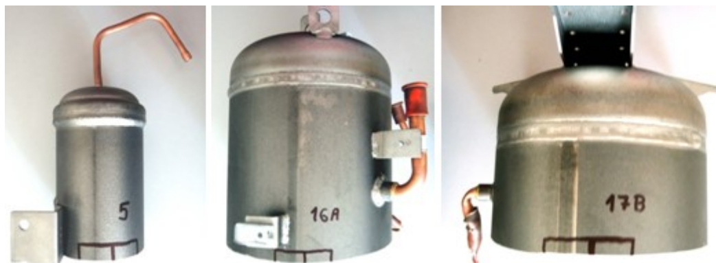
Obrázek č. 64 – Místa odběru vzorků pro metalografii
