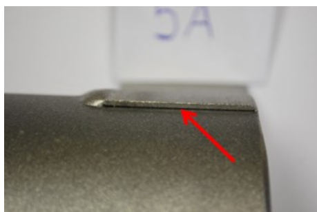
Obrázek č. 60 – Tlaková nádoba 5 A – Štěrbina, ostré hrany
