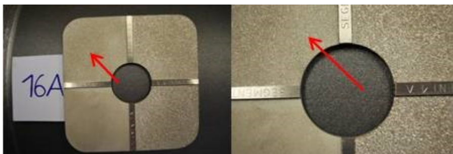
Obrázek č. 45 – Stanovení drsnosti – Tlaková nádoba 16 A
