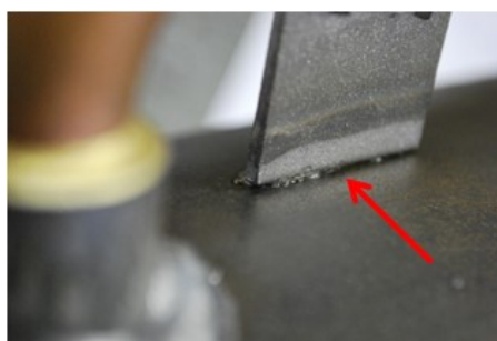
Obrázek č. 57 - Štěrbina + zbytky otryskávacího prostředku
