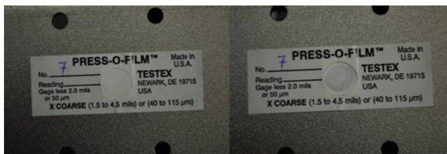
Obrázek č. 53 – Stanovení kotvícího profilu – Tlaková nádoba 17 B
