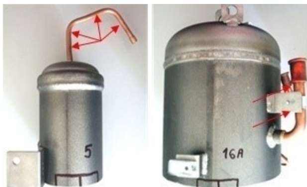
Obrázek č. 85 – Místa odběrů vzorků pro metalografii
