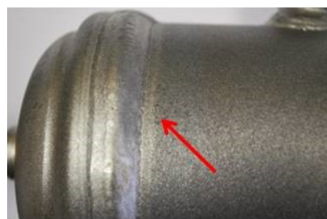
Obrázek č. 62 – Okuje na povrchu
