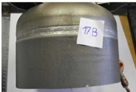
Obrázek č. 39 – Stupeň čistoty – Tlaková nádoba 17 B
