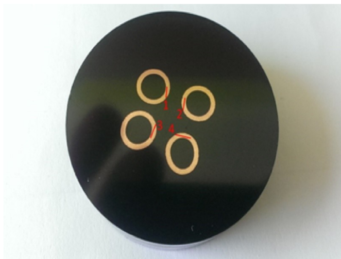
Obrázek č. 84 – Metalografický vzorek – Průřez měděné trubky, 1-4 – vektory měření mikrotvrdosti – měření od otryskaného vnějšího povrchu k základnímu materiálu vnitřního povrchu
