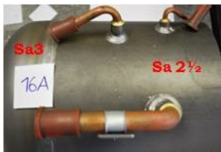
Obrázek č. 38 – Stupeň čistoty – Tlaková nádoba 16 A
