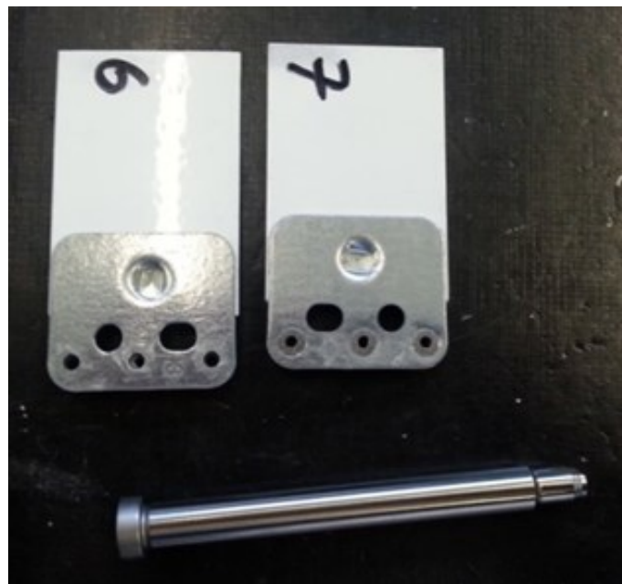
Obr. 38 Vzorky pro pevnostní zkoušku v tahu a použitý razník
