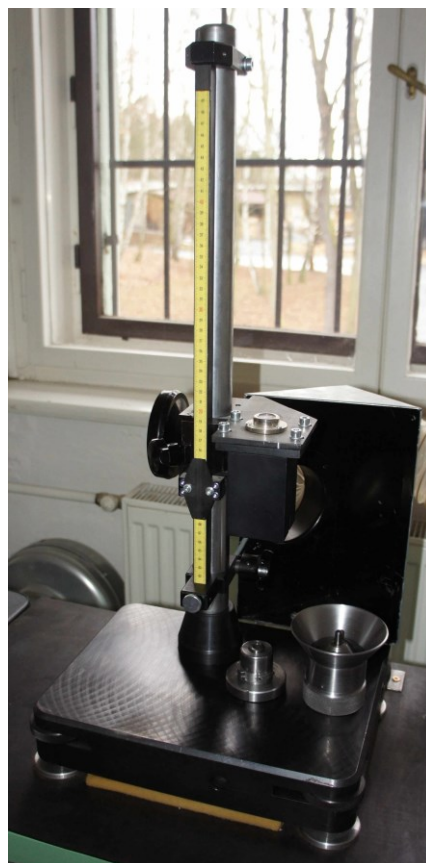
Obrázek 9.4 Pádový přístroj KX4 [vlastní]
