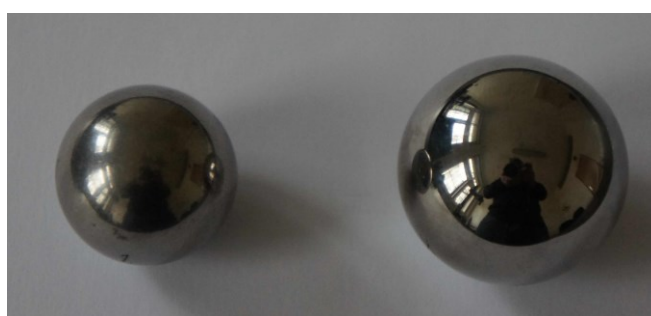
Obrázek 9.3 Zkušební závaží 55g vlevo, 112g vpravo [vlastní]
