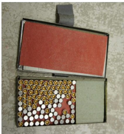
Obrázek 9.2 Zápalky uložené v pouzdře vlevo, natřásací přístroj vpravo [vlastní]
