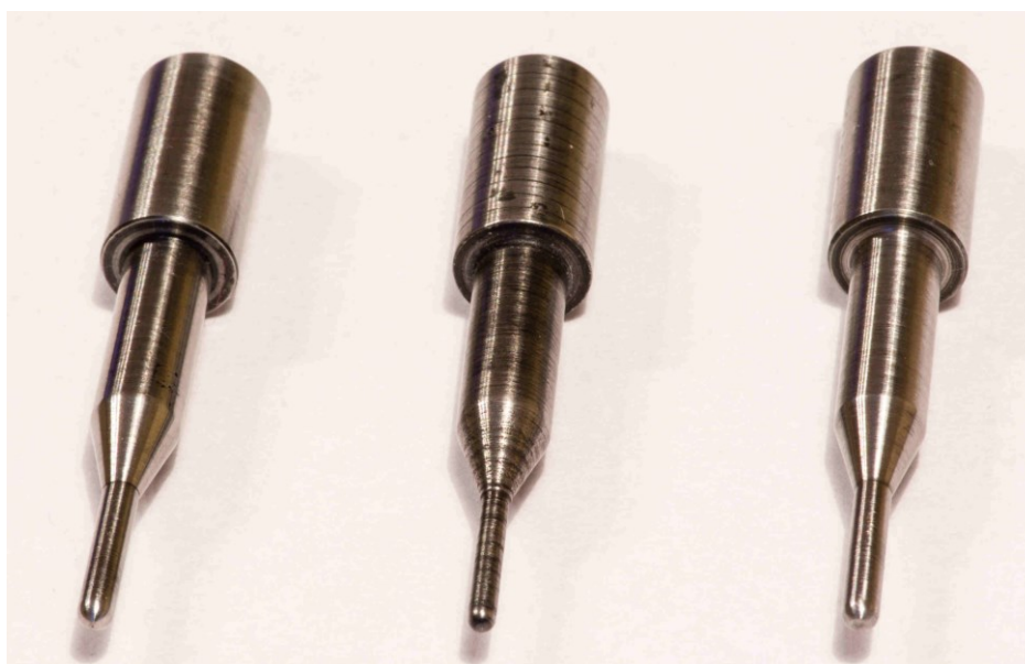
Obrázek 9.6 Zápalníky pro 9 mm Luger vlevo, 5,56x45 uprostřed a 7,62x51 vpravo [vlastní]
