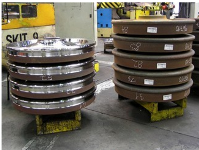
Obr. 4 Kola před a po opracování [9]
