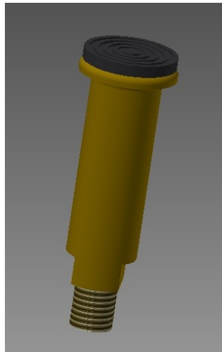
Obr. 47 Pevná opěrka s pryžovou dosedací plochou
