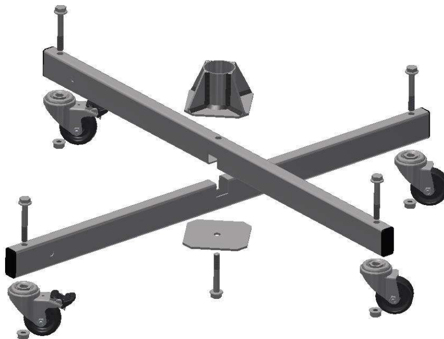
Obr. 8 – Konstrukční řešení základny
