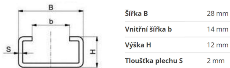
Obr. 42 C profil (rozměry) [38]
