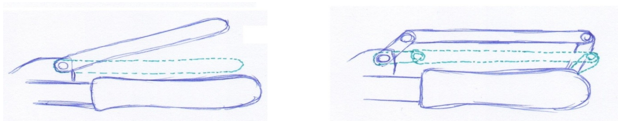
Obr. 14 Skica chodu brzdové páky
