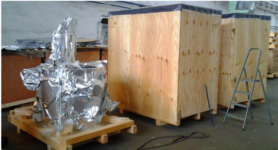
Obr. 2.7 Příprava na dlouhodobé skladování náhradních dílů [22]
